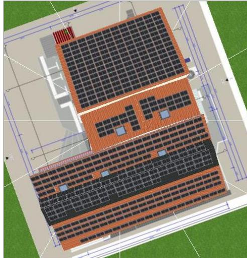
Abbildung 3.4: Sporthalle (Bestandsgebäude) mit PV Belegung (energielenker projects GmbH, 2022)
