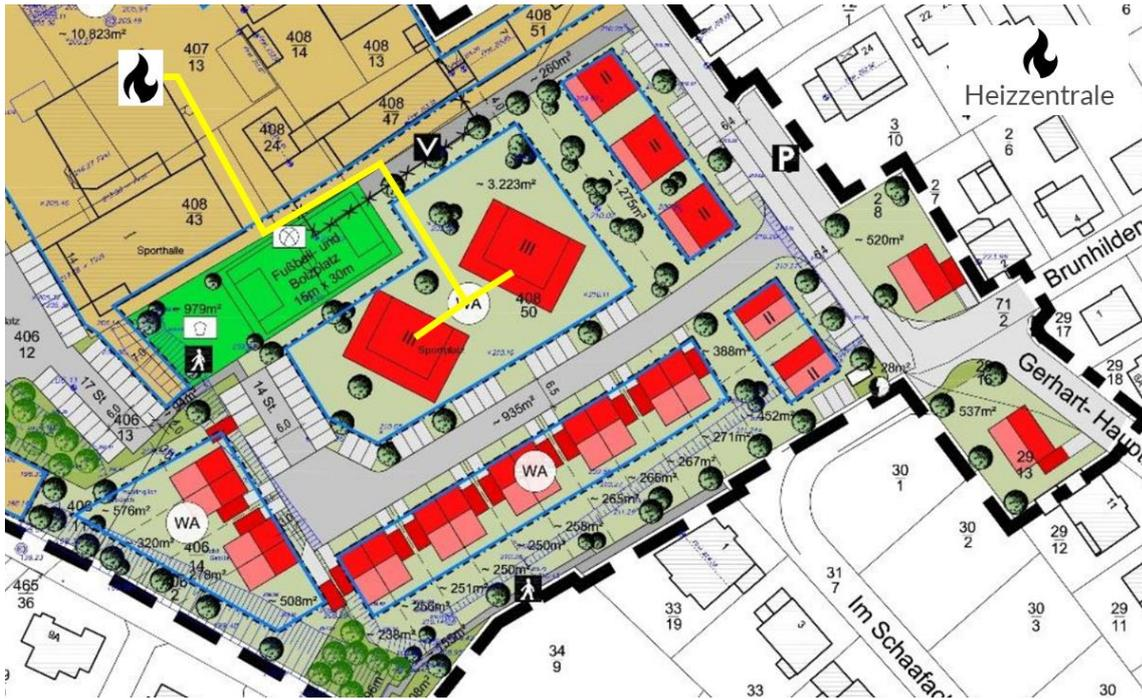
Abbildung 4.4: Potenzieller Verlauf eines warmen Nahwärmenetzes (energielenker projects GmbH, 2022)
