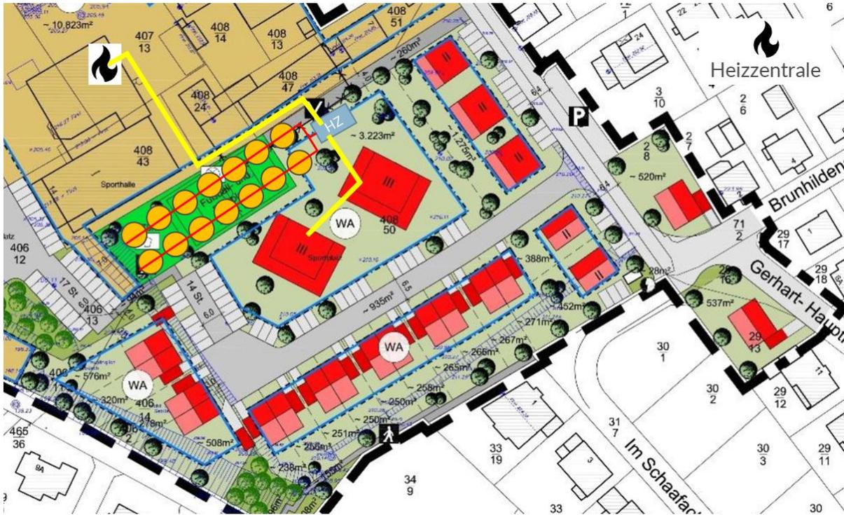
Abbildung 4.6: Potenzieller Verlauf eines warmen Nahwärmenetzes
