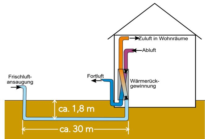
Beim Erdreich-Luft-Wärmetauscher kann die erforderliche Rohrlänge in Form von Schlangen oder einem Rohrregister realisiert werden.
