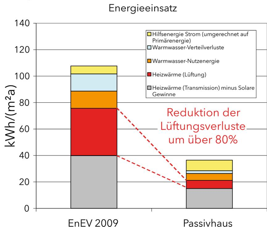
Ein Einfamilienhaus entsprechend der Energieeinsparverordnung 2009 mit Luftwechselrate  $0,6 \text{ h}^{-1}$  (Fensterlüftung) im Vergleich mit einem Niedrigenergiehaus, ausgestattet mit einer Lüftungsanlage mit Wärmerückgewinnung. Der Luftwechsel beträgt  $0,4 \text{ h}^{-1}$  und die Wärmerückgewinnung hat einen Wirkungsgrad von 80%.
