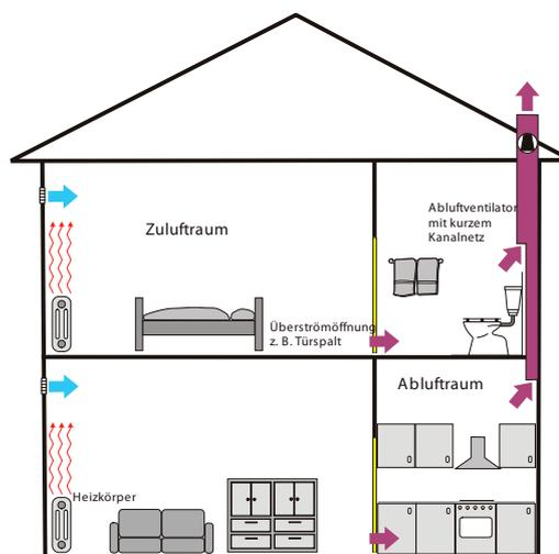
Die Grafik zeigt, dass eine Abluftanlage relativ einfach zu installieren ist. Es genügt ein Ventilator und ein kurzes Kanalsystem, das die Ablufträume erreicht. In den Zulufträumen werden Luftdurchlässe in die Wände oder in den Fensterrahmen eingebaut.
