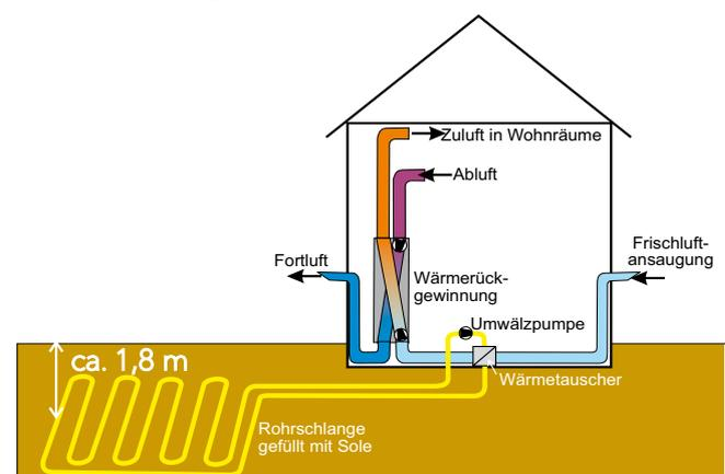
Beim Erdreich-Sole-Luft-Wärmetauscher wird die Erdwärme mit einem Wärmeträgermedium auf die angesaugte Außenluft übertragen.
