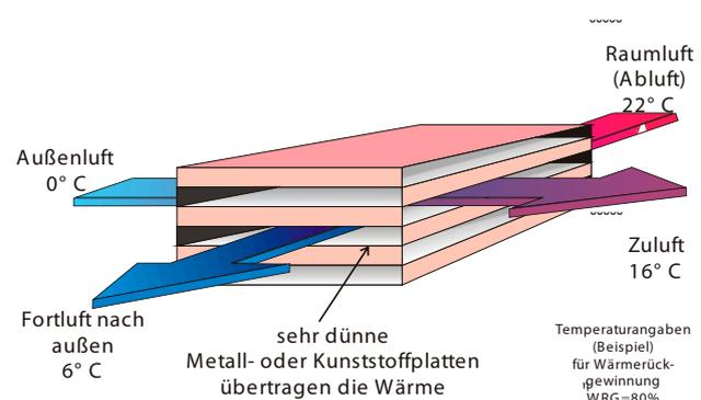
Die Prinzipdarstellung eines Plattenwärmetauschers
