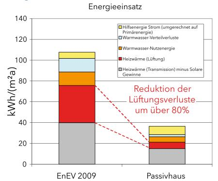
Ein Einfamilienhaus entsrechend der Energieeinsparverordnung 2009 mit Luftwechselrate 0,6 h<sup>-1</sup> (Fensterlüftung) im Vergleich mit einem Niedrigenergiehaus, ausgestattet mit einer Lüftungsanlage mit Wärmerückgewinnung. Der Luftwechsel beträgt 0,4 h<sup>-1</sup> und die Wärmerückgewinnung hat einen Wirkungsgrad von 80%.
