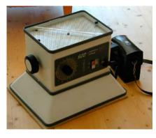
Ein Messgerät zur Bestimmung der Volumenströme an Zu- und Abluftventilen
