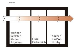
Das Konzept der Querlüftung hat den Vorteil, dass eine geringere Luftmenge ausreicht und auch die Bereiche zwischen den Haupträumen belüftet werden.
