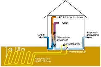
Beim Erdreich-Sole-Luft-Wärmetauscher wird die Erdwärme wird mit einem Wärmeträgermedium auf die angesaugte Außenluft übertragen.
