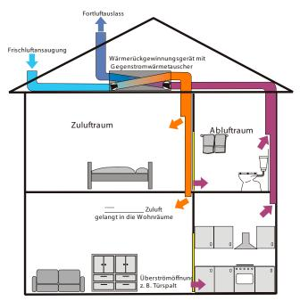
Schema einer Lüftungsanlage mit Wärmerückgewinnung
