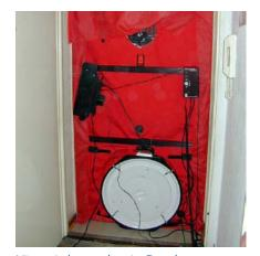
Hier wird gerade ein Drucktest vorgenommen. Ein Spannrahmen klemmt die Messeinrichtung im Türrahmen fest.
