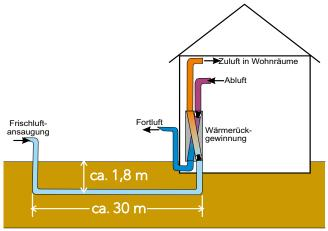
Beim Erdreich-Luft-Wärmetauscher kann die erforderliche Rohrlänge in Form von Schlangen oder einem Rohrregister realisiert werden.
