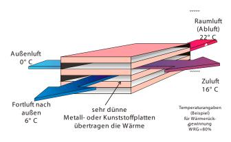
Die Prinzipdarstellung eines Plattenwärmetauschers
