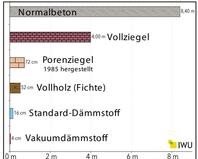
Vergleich von Materialstärken, die nötig sind, um eine Wärmedämmeigenschaft (U-Wert; früher k-Wert) von  $0,2 \text{ W}/(\text{m}^2\text{K})$  zu erreichen. Der Wert steht für den Standard, der heute beim Bau von Wänden für Niedrig-Energie-Häuser realisiert wird.
