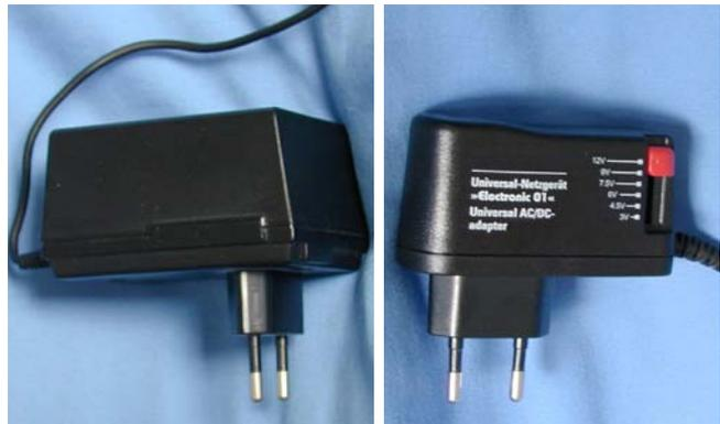
Der kleine Unterschied: Links ein Steckernetzteil herkömmlicher Bauart mit Transformator; Leistungsaufnahme im Leerlauf etwa 5 Watt. Rechts daneben ein elektronisches Universalnetzteil gleicher Leistung. Dessen Leistungsaufnahme im Leerlauf beträgt aber nur 0,5 Watt. Ist das Gerät ständig am Netz, dann ergibt sich pro Jahr eine Einsparung von über 39 kWh.
