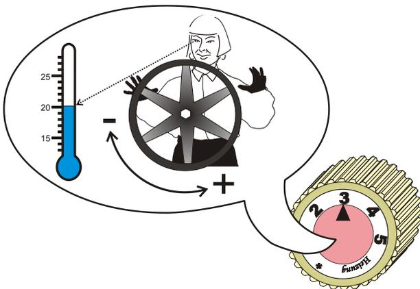
Die Regelung im Thermostatventil: Der Durchfluss wird so dosiert, dass der Raum die eingestellte Temperatur erreicht. Trifft diesen Regler kalte Luft vom offenen Fenster, wird das Ventil ganz geöffnet.
