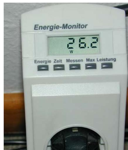
Einfache, z.B. in Baumärkten erhältliche Leistungsmesser helfen bei der Suche nach heimlichen Verbrauchern. Hier wird der Leistungswert für einen „ausgeschalteten“ Computerarbeitsplatz angezeigt.
