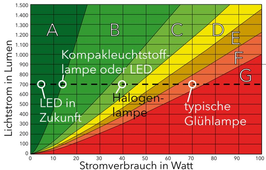
Der Stromverbrauch einer Lichtquelle in Relation zu dem Lichtstrom gemessen in Lumen ist der Maßstab zur Einteilung in die Effizienzklassen von A bis G. Als Beispiel für eine Beleuchtungsaufgabe die 700 Lumen erfordert ist die gestrichelte Linie eingetragen. Die Glühlampe braucht für diesen Zweck etwa 70 Watt (Klasse F), während die Leuchtstofflampe oder LED mit etwa 13 Watt auskommt (Klasse A oder B).
